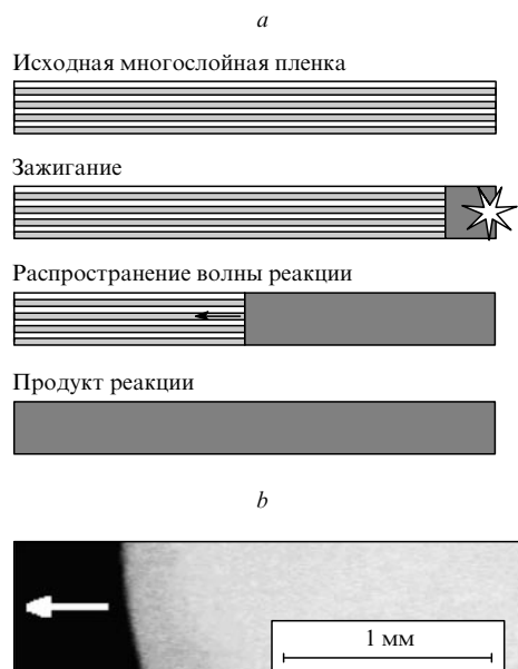
Рис. 1. Схема реализации реакционной волны в нанопленке (a) и видеокадр реакционной волны 8 в пленке Ti/3Al (b).
